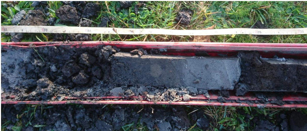
Boring 2 (160 – 230 cm –mv): opgebracht veen en zand (tot 185 cm –mv) op toemaakdek (tot 215 cm –mv) op veen.
